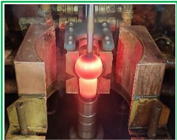
電磁コイルによる焼入れで表面を硬化させ、ボールスタッドの耐摩耗性・疲労強度を向上させています。
