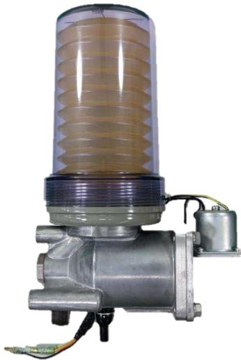
エア駆動型ピストンポンプでソレノイドバルブのONでディストリビュータにグリスを送ります
