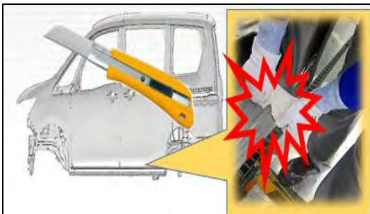
図3 電着塗装後も鉄板のエッジ部は刃物と同等に危険!!
