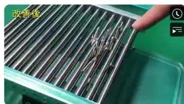
200個のばねを一度で挿入！ 治具
