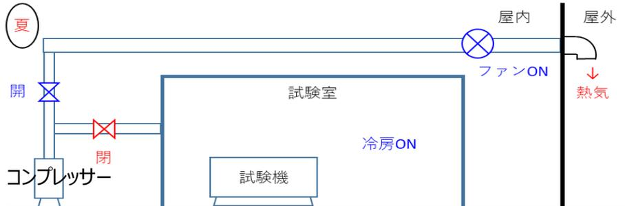
工場内にホースの耐久試験を行う部屋を設置した。品質管理上、室温は20～30℃を維持する必要があり、空調機を設置。そこで試験機付帯コンプレッサーからの排熱を冬季の暖房に利用したところ、冬季の空調機電力負荷を大幅に低減し、試験環境を維持することに成功
