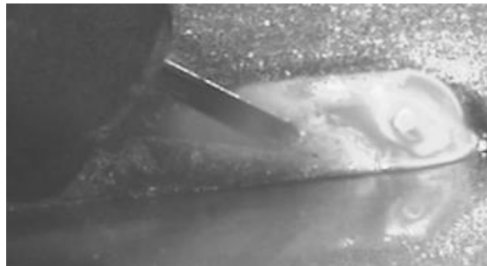
ハイスピードカメラによる「レーザ・アークハイブリッド溶接」の可視化
