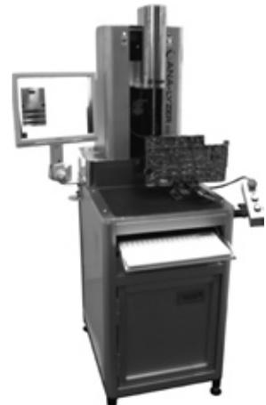
レーザー傷検査装置
