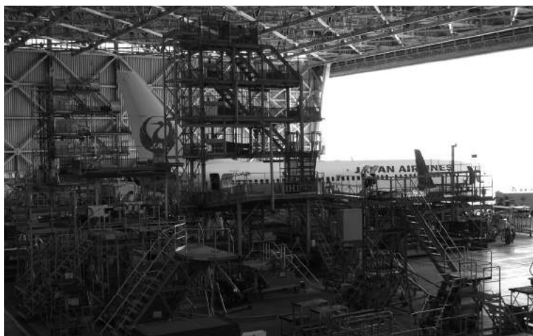
JALエンジニアリングのドック整備（重整備）の様子
