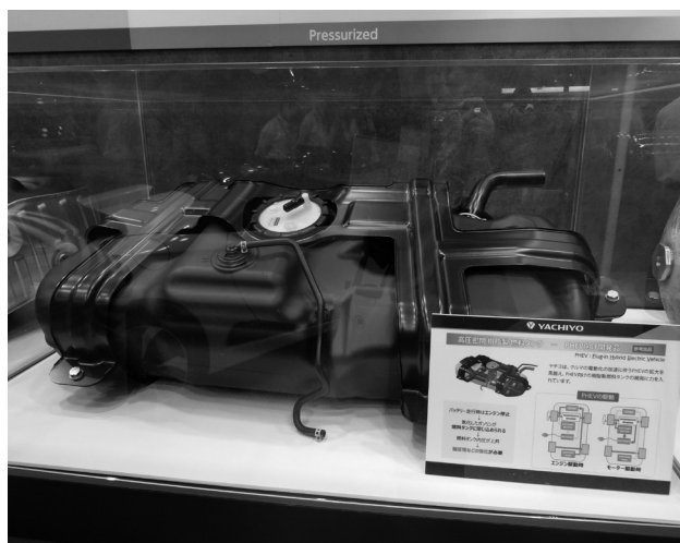
昨年開催された東京モーターショーに 八千代工業が出展したPHV向け燃料タンク
