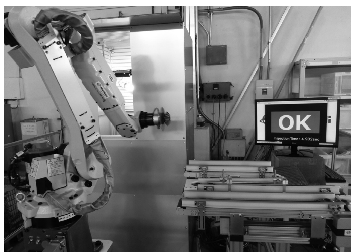
ロボットアームがカメラの前で製品を回転させ、画像をもとにAIが品質を判定
