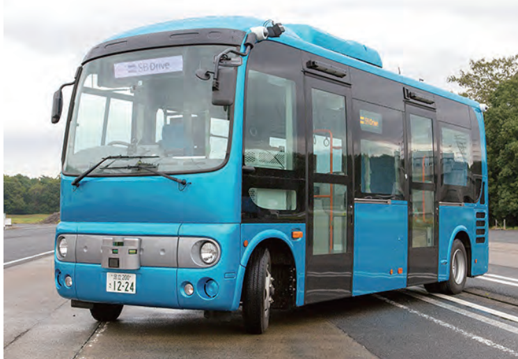
自動運転バスは、仏ナビヤ「アルマ」（写真上）と先進モビリティが製作した日野「ポンチョ」ベースの車両（同下）を使用する
