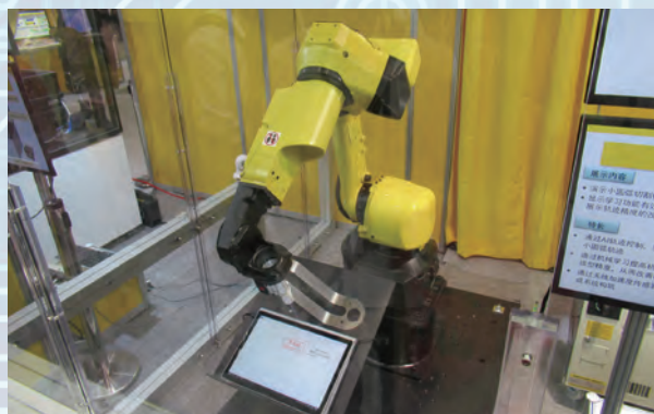
AIを使って高精度に軌道修正するロボット
