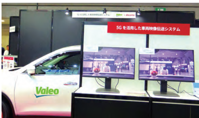
5G を活用した車両映像伝送システム (パートナー＝ヴァレオジャパン)。 車両カメラの映像をリアルタイムに伝送し、前車両の前方映像を後方車両に伝送し安全運転を支援
