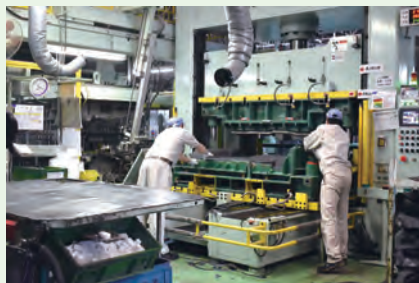
吸音材と遮音シートをプレスして貼り合わせる工程
