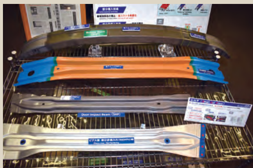
独自のホットスタンピング技術「スマートホットプレス」 を使ったビーム材
