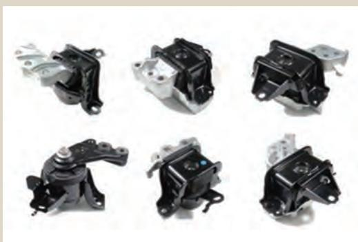
車両特性に合わせ最新技術を駆使したチューニングを得意とする液封入エンジンマウント
