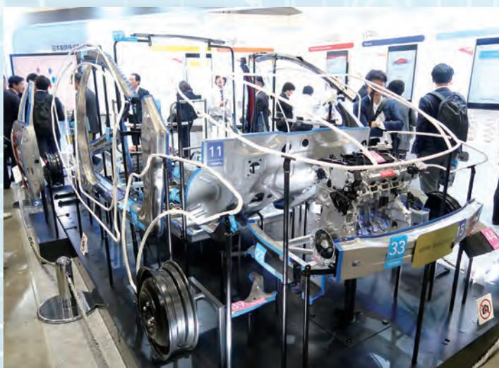
鉄鋼メーカーは鉄鋼素材のみの改良で30%の軽量化にチャレンジ
