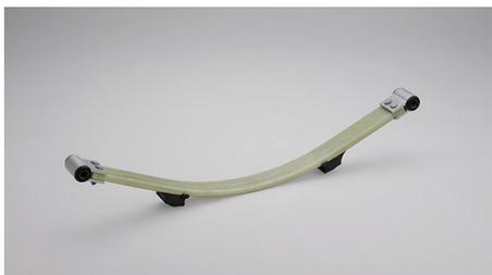
GFRP製で量産されている自動車懸架用の板ばね
