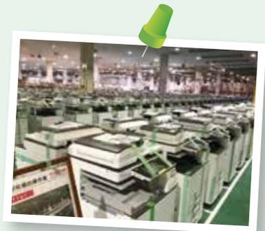
〈本体リサイクルエリア〉では、金属・樹脂部品の分別、自動清掃ロボットによる本体清掃を行い、その後〈本体リユース組立エリア〉を経て、再生機として完成を迎える。
