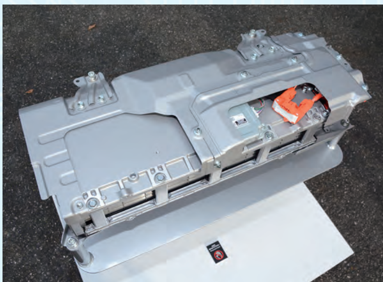
トヨタ自動車の「アクア」に搭載される「バイポーラ型ニッケル水素電池」
