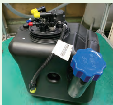
トラック用尿素水タンク
