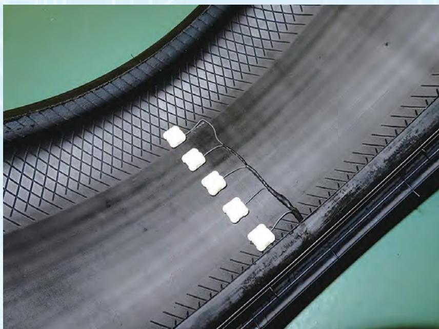
住友ゴムはタイヤ内側の小型センサーで摩耗状態を推定する技術を開発
