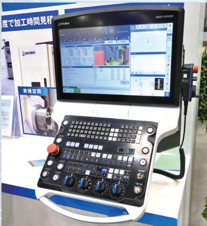
オークマが刷新した数値制御装置（CNC）は「デジタルツイン」での機械加工の事前検証が可能
