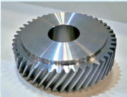
EV用ギヤには伝達効率や静粛性が求められ、高精度の切削加工が欠かせない
