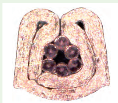
繊維銅電線をバルーンバレル端子で圧着した断面
