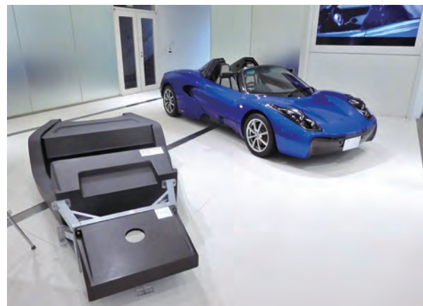
「TEEWAVE® AR1」とCFRP製モノコック
