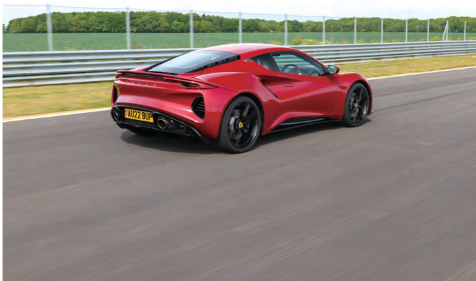
帝人の複合成形材料「GF-SMC」で軽量・三次元曲線のボディを実現したロータス「エミラ」
