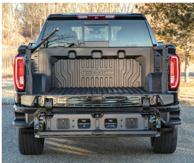
リサイクル可能な熱可塑性CFRP「Sereebo」を荷台に用いたGM「シエラ」
