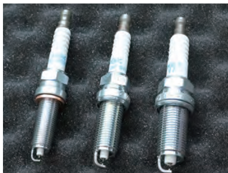
エンジンの燃焼効率を上げるため プラグは細く長い形状へ進化
