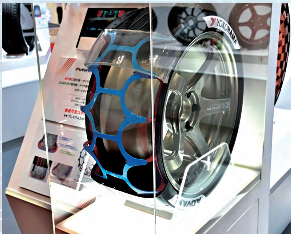
横浜ゴムの「フューチャースポーツタイヤコンセプト」は走行条件に合わせて内部構造の硬さが変化する
