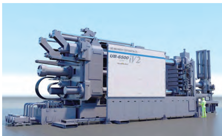
「ギガキャスト」に用いる超大型ダイカストマシン
