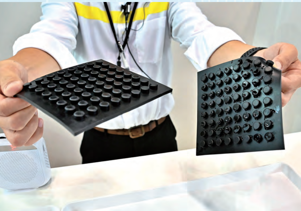
住友ゴムのアクティブトレッド技術は、路面の水分や温度に応じてゴムの特性が変わる（右）
