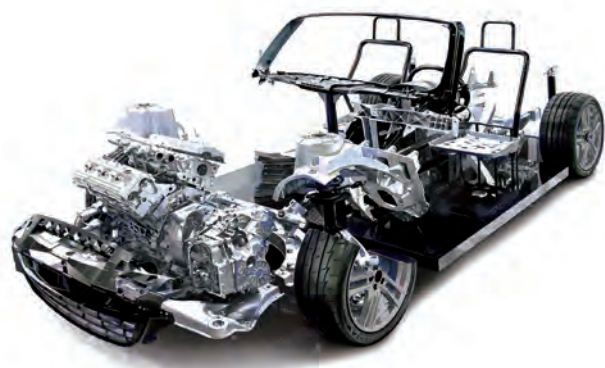
アルミダイカストは車両のさまざまなパーツに使われている
